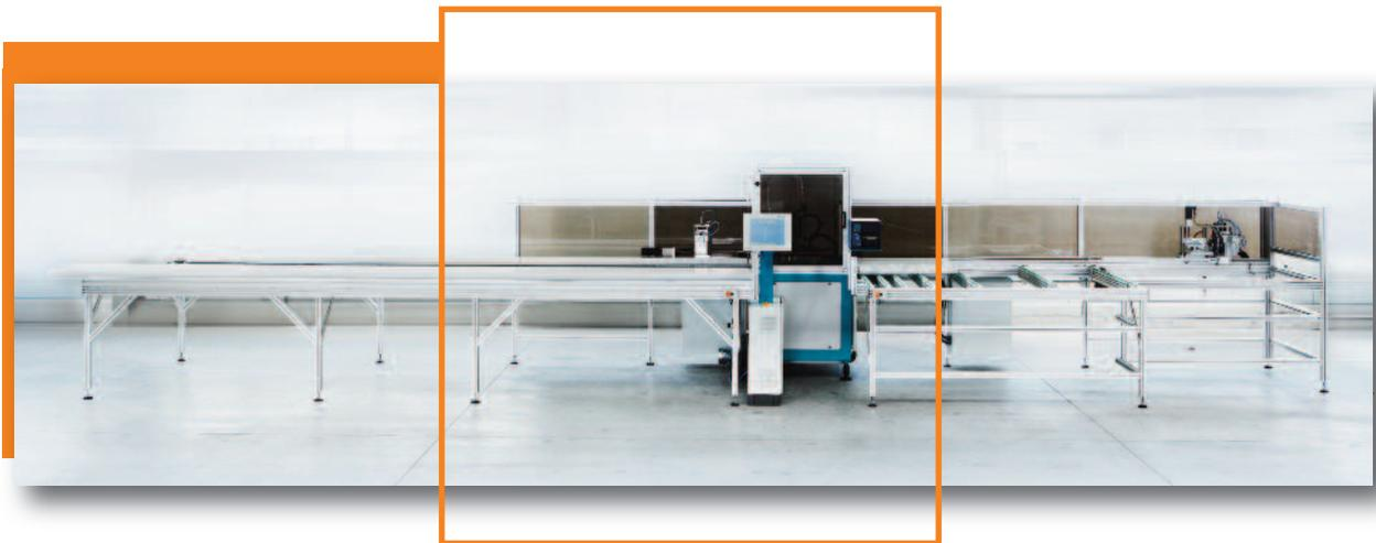
Der modulare und von allen Seiten zugängliche Aufbau des ASZ gewährleistet den schnellen Sägeblattwechsel, die einfache Wartung und Instandhaltung. Alle wichtigen Komponenten, wie Steuerung, Bedienerführung via Touch-Screen Monitor, Scanner sowie Zu- und Abtransportpuffer wurden übersichtlich angeordnet.
