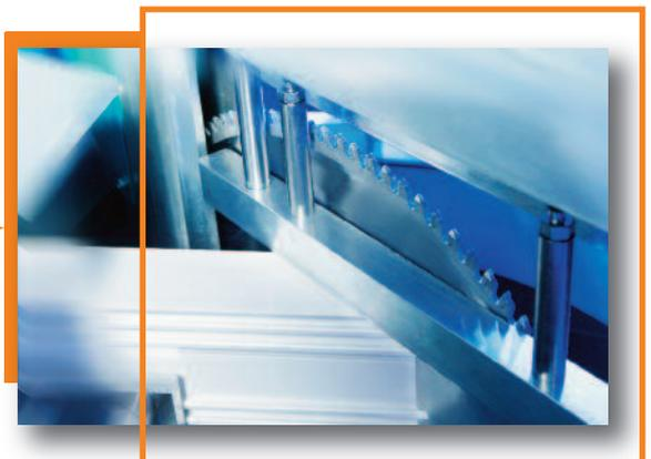
Der Sägekopf des ASZ wird über einen Servomotor in einem Bereich von 22,5° bis 157,5° stufenlos verstellt. Die Positionierung der Profilstäbe in Längsrichtung erfolgt über zwei programmgesteuerte Servoachsen.
